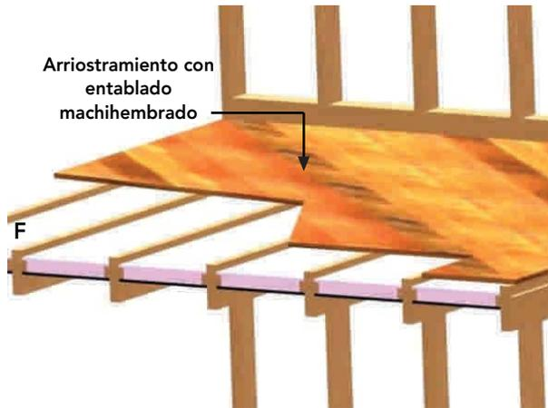
**Figura 9 - 11:** Ejemplo en el cual se ha especificado como solución de riostra y pavimento terminado a la vista, molduras a 45°, de 114 x 19 mm machihembrada, con aislación termo-acústica para la plataforma del entrepiso.
