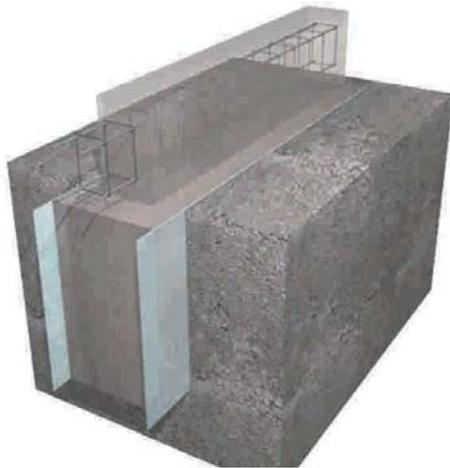
**Figura 8 - 32 :** Fundación continua con sobrecimiento de hormigón armado.
