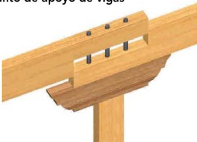
Figura 7-1 : Necesidad de unir dos vigas en un apoyo.
