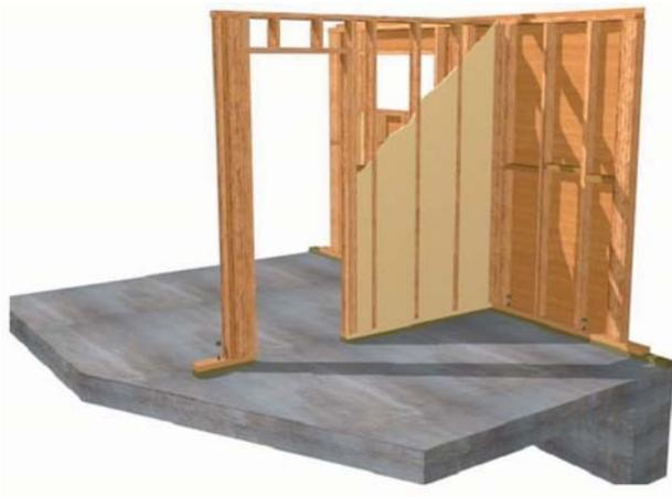
**Figura 14-81:** Vista entramado y revestimiento estructural de tabiques.
