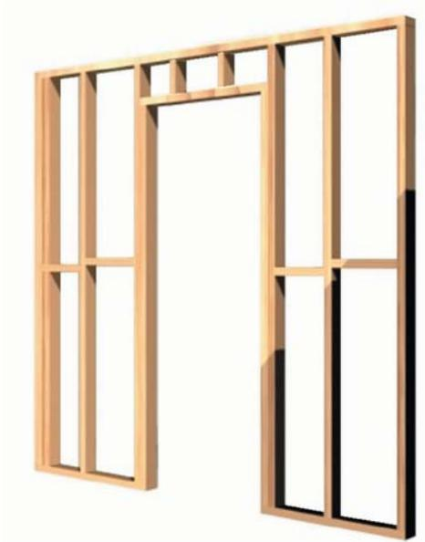
**Figura 14-80:** Estructura del tabique.
