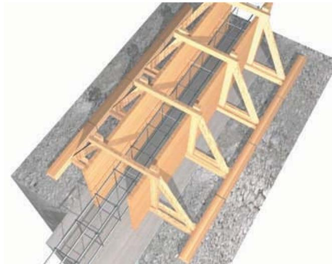
*El encofrado de madera debe asegurar la geometría y permitir que no haya deformaciones en la compactación del hormigón.*
