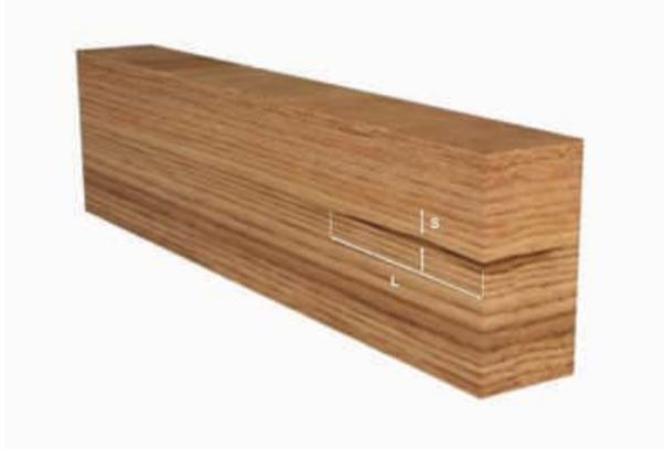
Figura 1 - 50: Forma y medición de una acebolladura.
