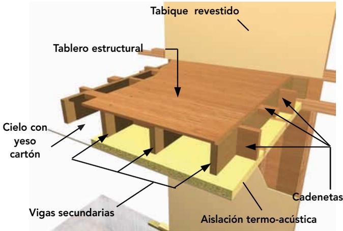
Figura 20-11: Elementos de la plataforma de entepiso y disposición del tablero estructural.
