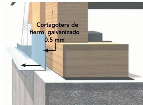
**Figura 14-39:** Como complementación a la protección de la solera de montaje y revestimiento exterior en el caso de fundación continua, es recomendable instalar cortagotera de hierro galvanizado, que permite eliminar el agua lluvia de dicho sector.
