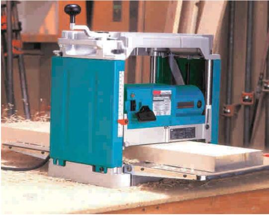
Figura 5 - 49 : Cepillo con calibradora de cuchillas.
