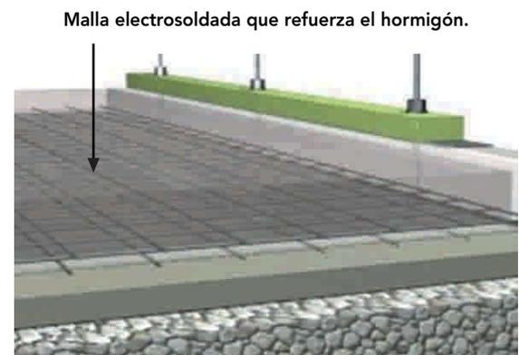
**Figura 8 - 56:** Colocación de la malla electrosoldada sobre separadores plásticos de 2 cm sobre la barrera de humedad.
