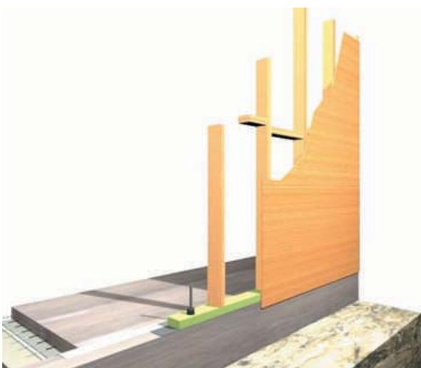
Tabique conformado por pie derecho de 2 x 4, dispuestos cada 400 mm, cadeneta corta fuego, arriostamiento con placa estructural terciado fenólico y aislación térmica.
