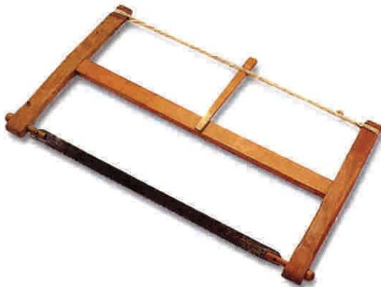
Figura 5 - 2 : Sierra común con estructura de madera.
