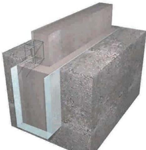
**Figura 8 - 23:** Sobrecimiento al que se le incorporó armadura de fierro según cálculo. Terreno de fundación es inferior a 2 kg/cm<sup>2</sup>.
