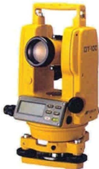
Figura 5 - 63 : Taquímetro.
