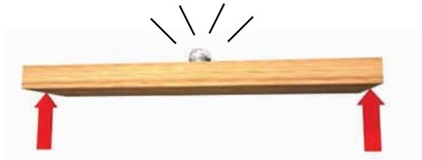
Figura 1 - 32: Esquema de ensayo de tenacidad.
