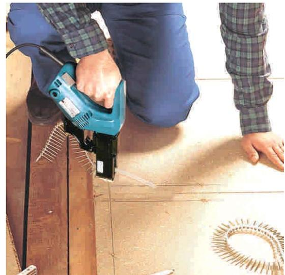
Figura 5 - 39 : Atornillador eléctrico.
