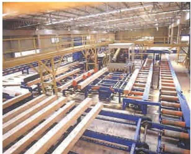
Foto 1 - 16: Aserradero automatizado donde la madera es dimensionada.
