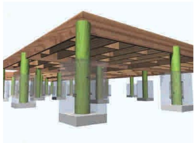
**Figura 3 - 3:** Fundación aislada, pilotes impregnados (C.C.A).
