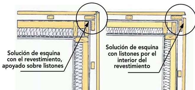
**Figura 18 - 21:** Soluciones para el encuentro en las esquinas de los revestimientos dispuestos en forma horizontal.
