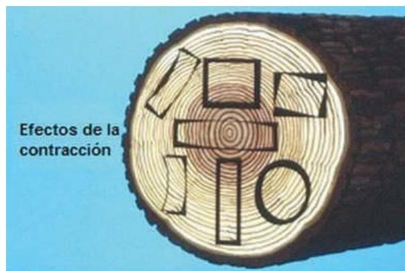
Figura 1-28: Efectos de la contracción en la madera.
