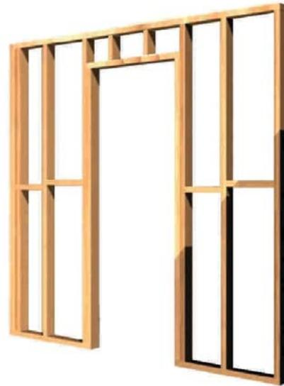
**Figura 10 - 3a:** Elevación de un tabique autosoportante prefabricado.
