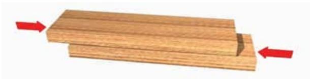
Figura 1 - 33: Esquema de ensayo de cizalle longitudinal.
