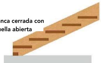
Figura 12 – 15: Zanca abierta y cerrada. Escalera con contrahuella ciega y abierta.
