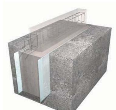
*Sobrecimiento armado según cálculo, con cemento protegido de la humedad directa del suelo.*
