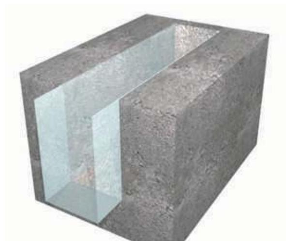
Excavación del cemento, ancho y profundidad según cálculo, membrana de polietileno de 0,5 mm como barrera de humedad.
