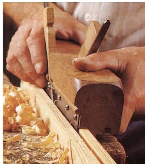
Figura 5 - 15 : Machihembrador.
