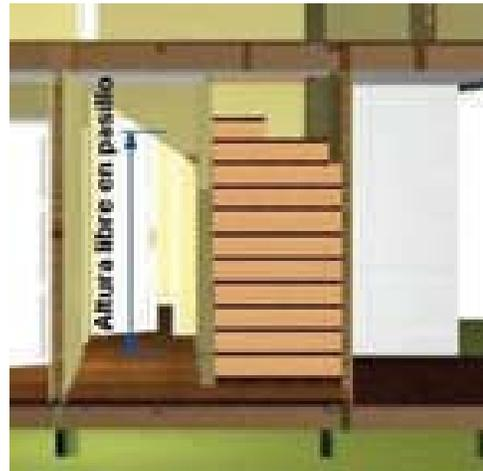
**Figura 12 - 18:** Se debe verificar la altura libre del pasillo en el sector medio, cuando la estructura de la escalera compromete la totalidad o parte del cielo raso del recinto.
