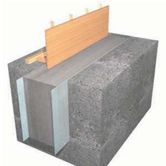
Hormigón de cemento con bolón desplazador (20 a 30 %) y dosificación según cálculo, superficie rugosa para una buena adherencia con el hormigón del sobrecimiento.
