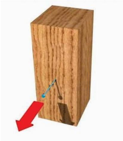
**Figura 1 - 42:** Esquema de ensayo de extracción de clavo.
