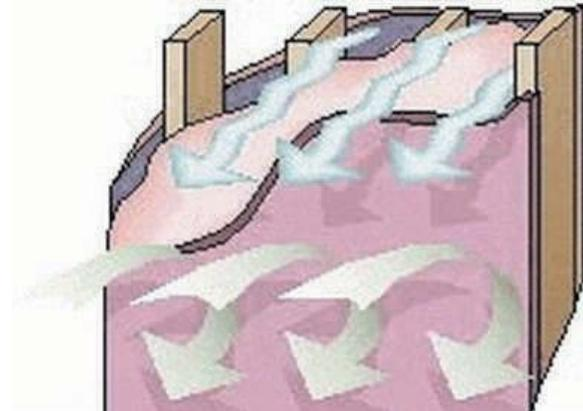
**Figura 14-23:** Flujo de aire y vapor al interior de la vivienda que se puede condensar, dañando el recubrimiento de los paramentos y el material aislante.
