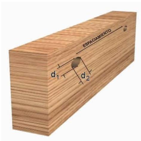
**Figura 1-44:** Medición de agujero y/o nudo suelto en el borde de la cara.
