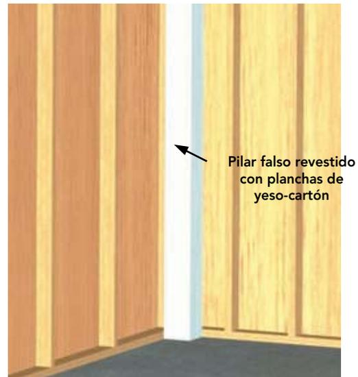
**Figura 16-15:** Finalmente, se reviste la estructura de madera con el mismo material de los muros. En este caso se ha especificado plancha de yeso cartón de e = 15 mm.
