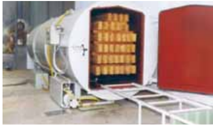
Figura 28. Autoclave para el método de doble vacío.
