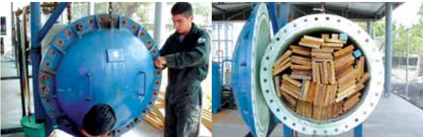
Figura 29. Autoclave para presión y vacío.
