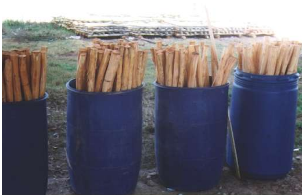
Figura 6: Método de ascensión capilar - Postes de álamo en Sulfato de Cobre
