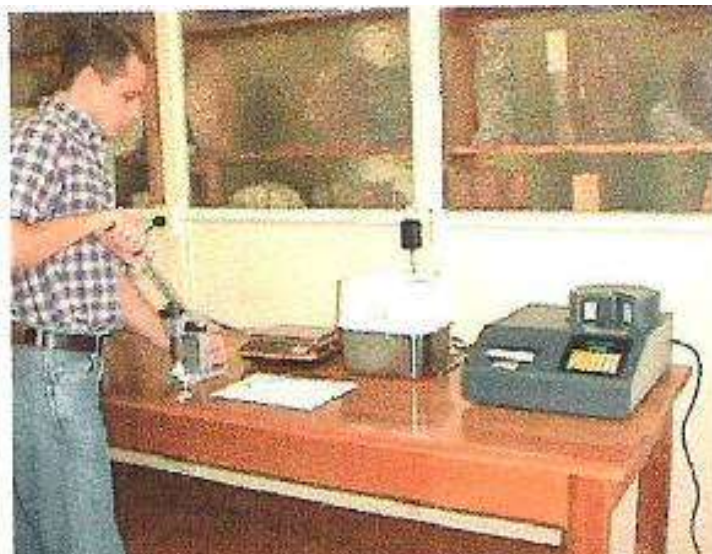
Figura 5: Determinación de retención por espectrometría de fluorescencia de rayos X
